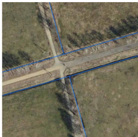
Ryc. 25. Kameralna digitalizacja rowów na podstawie numerycznych modeli terenu oraz ortofotomapy (źródło: opracowanie własne z wykorzystaniem danych GUGiK).
