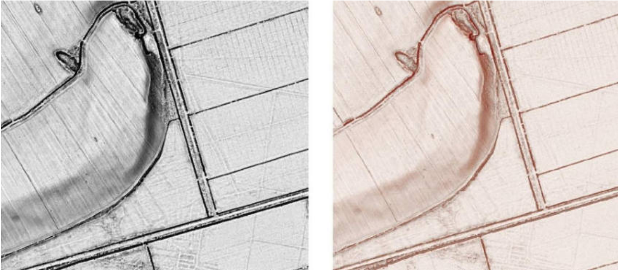
Ryc. 3. Wizualizacje wykonane na podstawie Numerycznego Modelu Terenu - VAT po lewej i VAT + slope po prawej (źródło: opracowanie własne z wykorzystaniem danych GUGiK).
